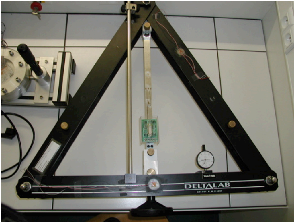
Etude des déformations d'un réservoir sous pression
